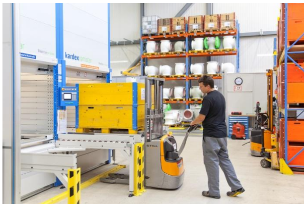
Imagen 2: Almacenamiento simple y recuperación de pallets con una transpaleta o carretillas eléctricas gracias al dispositivo de extracción de la bandeja.
