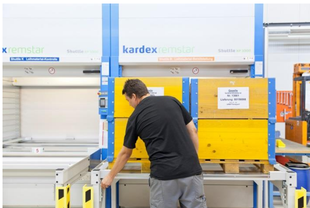
Imagen 3: Comprobadas las devoluciones, se almacenan temporalmente en la lanzadera de la izquierda. La lanzadera de la derecha sirve como sistema de almacenamiento de memoria interna para sets de herramientas que aún no están totalmente recogidas.
