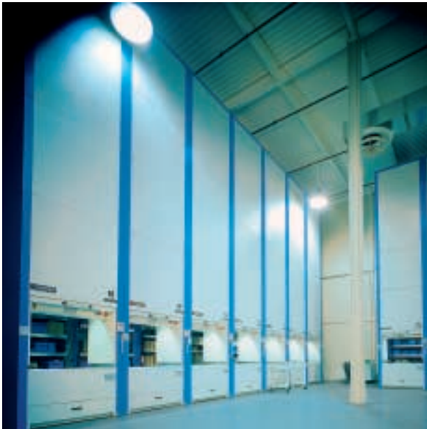
Eine typische Installation des Geschäftsbereiches Dynamische Lager- und Bereitstellungssysteme (KRM): Eine Reihe von Kardex-Shuttle-Modulen bilden die Logistiklösung für die zentrale Lagerung und die Bereitstellung von Komponenten und Ersatzteilen.
