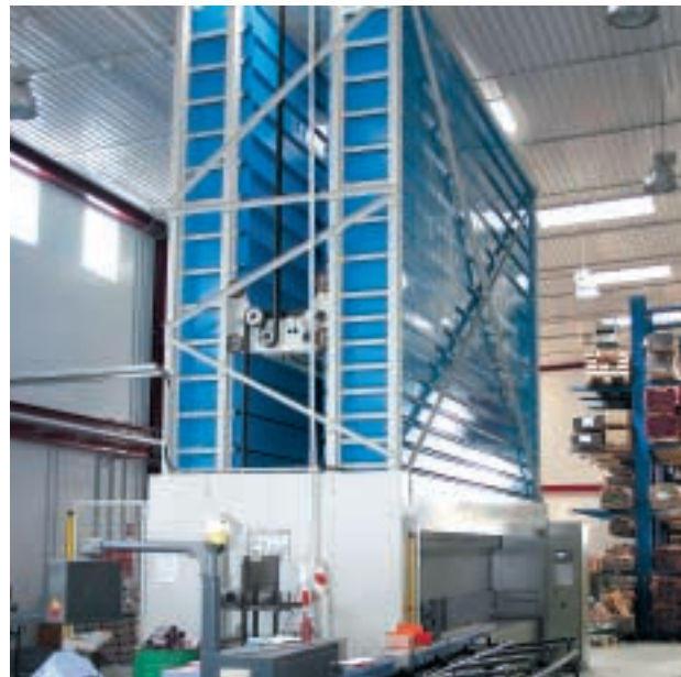
Eine typische Lösung nach Mass der Speziallager-Technik (STE): Ein STE-Multi-Tower für Schwerlasten wird für die zentrale Lagerung von Langgut bis 6,8 m eingesetzt.
