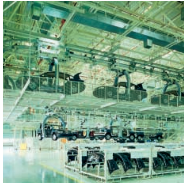
Ein typisches Projekt des Geschäftsbereiches Industrielle Automatisierungs- und Fördertechnik (AFT): AFT-Deckentransportsysteme führen entstehende Autos von Station zu Station einer automatischen Fertigungsstrasse.
